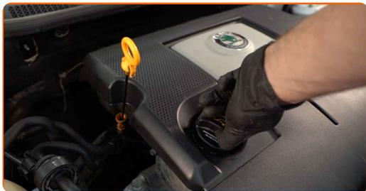
**34** Hæld olie ind i motoren gennem oliedæksel. Påkrævet oliemængde: 3.3 l.
