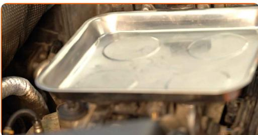
**14** Skru filterhusets dæksel af sammen med det gamle oliefilter element. Brug en kombinøgle № 36.
