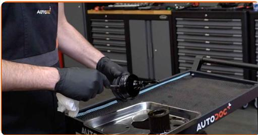
**19** Rengør oliefilter hættten. Brug universal rengøringsmiddel.
