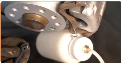
**32** Forbind bremse udluftningssættet til bremseudluftningsskuen.
