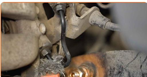
**8** Løsen befæstigelsen der forbinder bremserøret til bremseslangen. Brug en kombinøgle N° 11.
