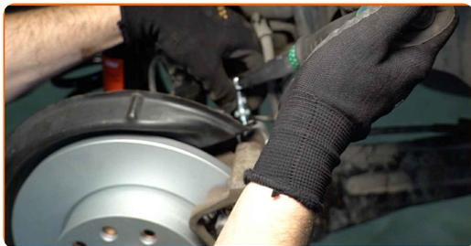
**35** Afbryd bremse udluftningssættet.
