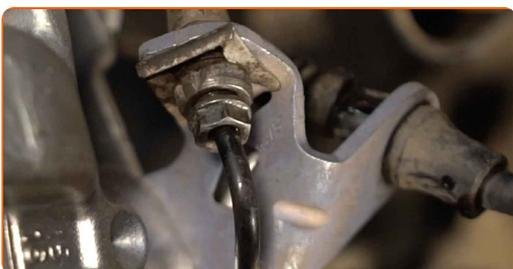
**29** Installer bremseslange holderklipsen. Brug en gummihammer.
