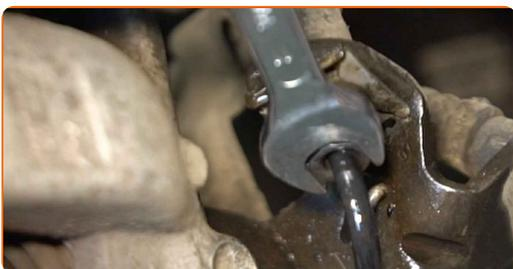
**10** Klem bremseslangen af ved brug af en bremseslange klemme.
