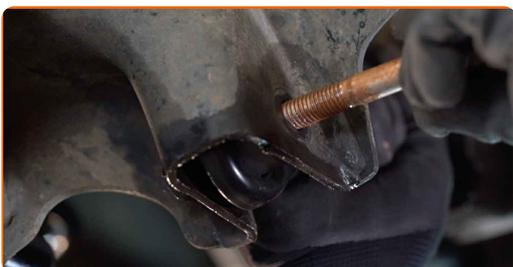
**13** Støt armen. Brug en hydraulisk løfteenhed.
