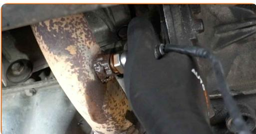
**11** Stram oxygen sensorens befæstigelse. Brug en kombinøgle N° 22. Brug en momentnøgle. Stram den til 47 Nm moment.
