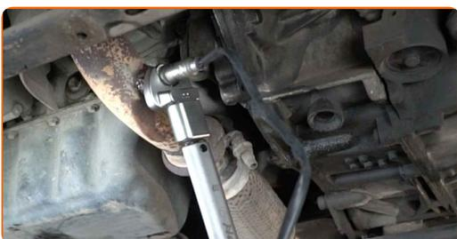
**12** Behandl oxygen sensoren stikket. Brug dielektrisk fedt.
