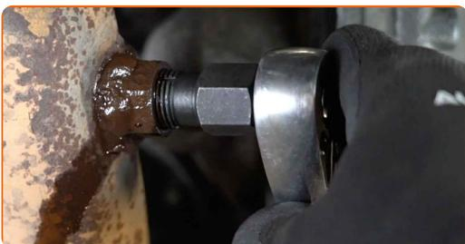
**9** Behandl oxygen sensoren. Brug kobberfedt.
