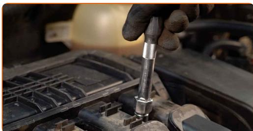
**10** Skru nye tændrør i og stram dem. Brug tændrørsnøgle #16. Brug en momentnøgle. Stram den til 28 Nm moment.
