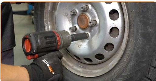
31 Sænk bilen og stram hjulboltene på kryds med. Brug hjul slagnøgle #17. Brug en momentnøgle. Stram den til 120 Nm moment.
