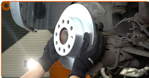
**19** Stram bremseskivens skruer. Brug Torx T30. Brug en momentnøgle. Stram den til 9 Nm moment.
