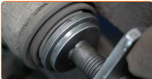
**26** Monter bremsekaliberen og sæt den fast. Brug en kombinøgle N° 15. Brug en topnøgle N°13. Brug en momentnøgle. Stram den til 35 Nm moment.
