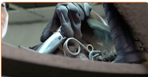
**27** Behandle overfladen hvor bremseeskiven har kontaktflade til hjulnavet. Brug kobberfedt.
