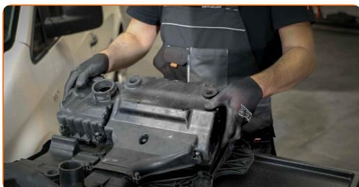
7 Fjern filterelementet fra filterhuset.
