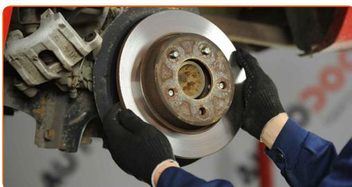
**19** Rengør navet. Brug en stålbørste. Behandel kontaktfladen. Brug kobberfedt.
