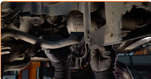
13 Skru befæstigelserne af stabiliseringsbøsning beslagene. Brug en topnøgle N°16. Brug en momentnøgle. Stram den til 28 Nm moment.
