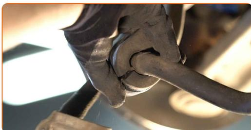
10 Rengør montagefladen til stabiliseringsbøsningerne. Brug WD-40 spray.
