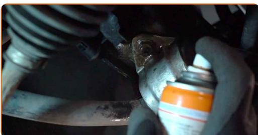
15 Behandle overfladen hvor bremsekiven har kontaktflade til hjulnavet. Brug kobberfedt.
