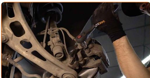
**11** Fjern bremsekaliberen.
