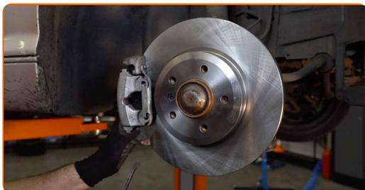
**31** Rengør bremseskivens overflade. Brug bremsrens.
