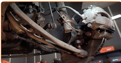
20 Støt styrekuglen. Brug en hydraulisk løfteenhed.
