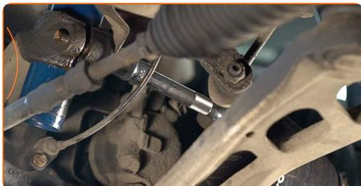
**49** Stram den nedre befæstigelses forbindelse mellem fjederben og styrespindel. Brug en topnøgle N°18. Brug en momentnøgle. Stram den til 80 Nm moment.
