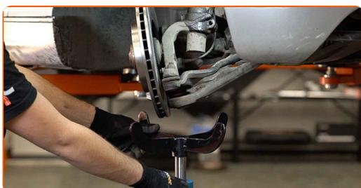
21 Frigør den nedre befæstigelse der forbinder fjederbenet til stubakslen. Brug særlige skiftenøgler for at fjerne støddæmperen.
