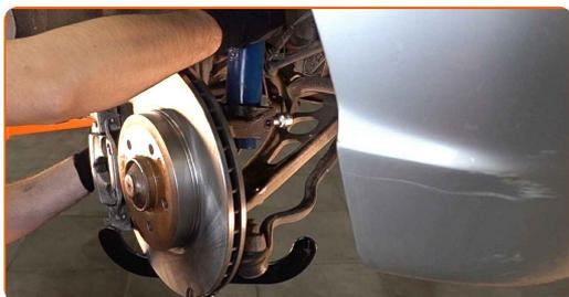
**48** Installer og spænd den nye bolt på styrespindlen.
