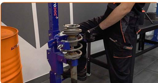
**29** Behandel fjederbenets stang. Brug en stålbørste. Brug WD-40 spray.
