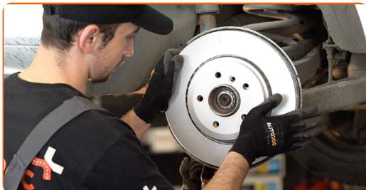
23 Stram bremseskivens skruer. Brug Torx T30. Brug en momentnøgle. Stram den til 16 Nm moment.
