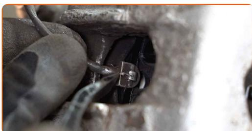
**34** Monter støvhætter på bremsekaliberens styretapper.
