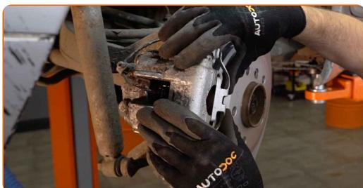
**36** Rengør bremseklodsernes overflade. Brug bremserens.
