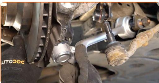
**20** Skru befæstigelsen der forbinder kugleledet til styrespindlen. Brug en topnøgle N°21.
