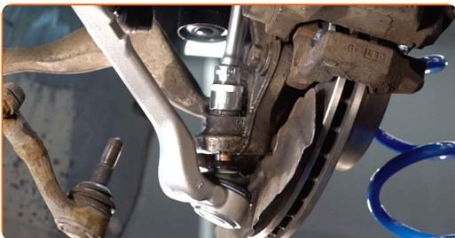
**21** Behandl befæstigelsen der forbinder forbindelsesstangen og styrespindlen. Brug kobberfedt.
