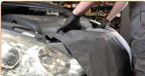
3 Frigør ekspansionsbeholderens holdere. Brug et panelclip værktøj.
