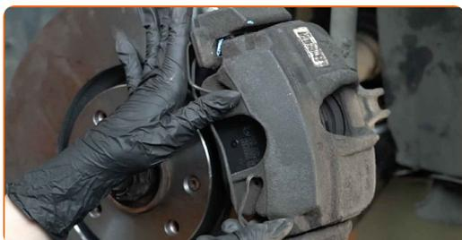
**33** Behandle overfladen hvor bremsekiven har kontaktflade til hjulnavet. Brug kobberfedt.
