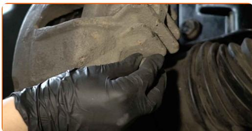
**32** Monter bremsekaliberens holdefjeder.
