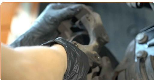
**18** Rengør bremseskivebefæstigelsen. Brug en stålbørste. Brug WD-40 spray.
