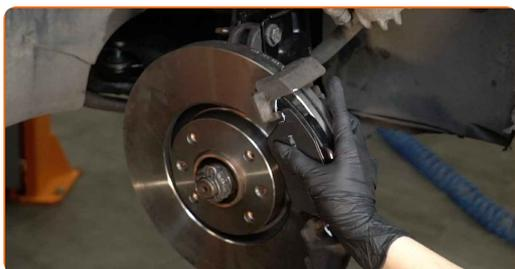
**30** Monter bremsekaliberen og sæt den fast. Brug HEX nr. H7. Brug en momentnøgle. Stram den til 30 Nm moment.
