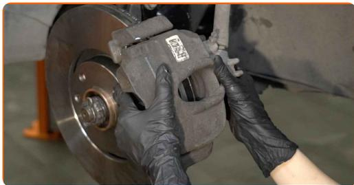
**31** Monter støvhætter på bremsekaliberens styretapper.
