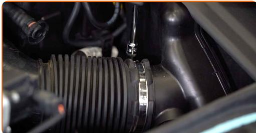
**9** Afbryd luftindsugningsrør fra luftfilterhuset.
