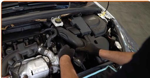
**8** Løsen klemmen og fastgørelsen på luftfilterindsugningsrøret. Brug en kombinøgle № 7. Brug en topnøgle №10.
