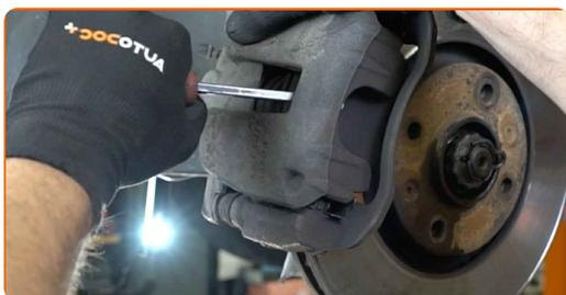
**13** Fjern bremsekaliberen. Brug et koben.
