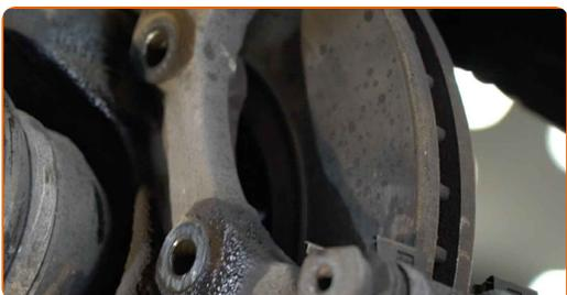
**19** Rengør bremsekivebefæstigelsen. Brug en stålbørste. Brug WD-40 spray.
