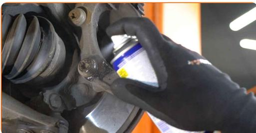
**16** Skru fastgørelserne til bremsekaliberens beslag af. Brug Torx T55. Brug en vridenøgle. Brug en skraldenøgle.
