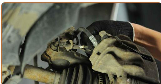
**11** Afbryd kablet til bremseklods slidsensor.
