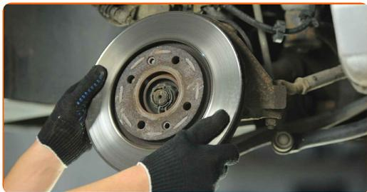
**22** Rengør navet. Brug en stålbørste. Behandl kontaktfladen. Brug kobberfedt.
