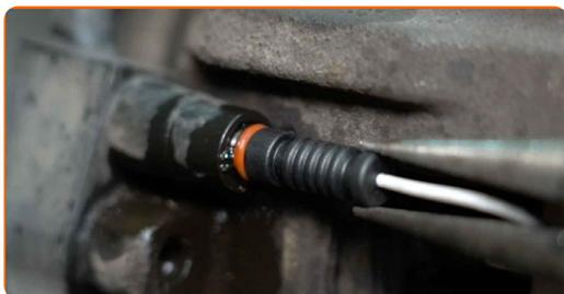
**24** Tilslut kablet til bremseklods slidsensor.
