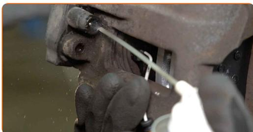
**23** Sæt bremseklodsens slidsensors stik i. Brug rundtænger.
