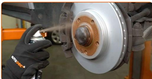
**26** Rengør bremsekivens overflade. Brug bremserens.
