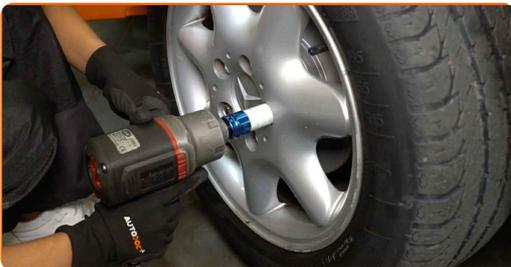
29 Sænk bilen og stram hjulboltene på kryds med. Brug hjul slagnøgle #17. Brug en momentnøgle. Stram den til 110 Nm moment.
