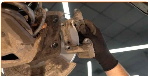
29 Stram bremsekaliberens beslag. Brug en kombinøgle № 16. Brug en momentnøgle. Stram den til 55 Nm moment.
