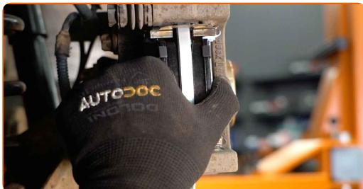
31 Behandel bremsekaliber cylinder. Brug bremserens.
