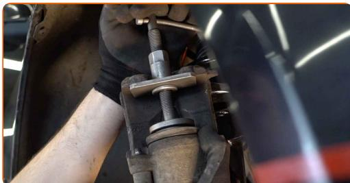
33 Monter bremsekaliberen og sæt den fast. Brug en kombinøgle № 13. Brug en kombinøgle № 15. Brug en momentnøgle. Stram den til 35 Nm moment.
