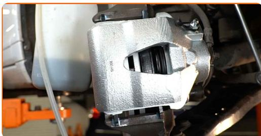
**27** Dræn bremsekaliber systemet. Tryk på bremsepedalen flere gange, indtil du kan mærke en betydelig modstand, uden at starte motoren.
