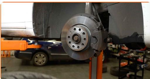
**7** Rengør området hvor bremseslangen er forbundet til bremsekalibren og bremsekredsløb rør. Brug en stålbørste. Brug bremsereens.
