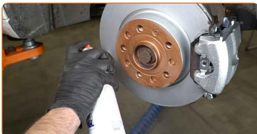
**Udskiftning: bremseklodser – Audi A3 8PA. Råd fra AUTODOC eksperter:**
