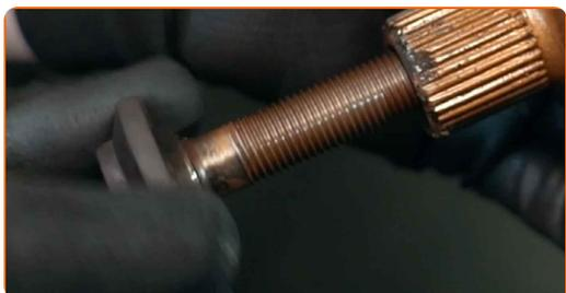
**24** Rengør drivakselledets monteringsæde. Brug universal rengøringsmiddel.
