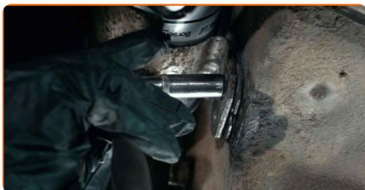
**16** Stram klammerne på brændstoffilter rørene. Brug en skruetrækker med lige kærve.
