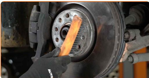
**24** Behandle overfladen hvor bremseskiven har kontaktflade til hjulnavet. Brug kobberfedt.
