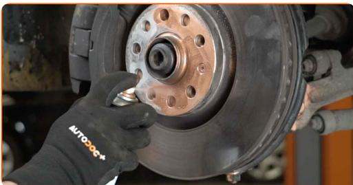
**25** Rengør bremseskivens overflade. Brug bremsrens.
