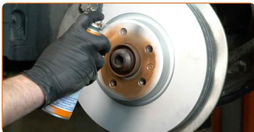
**31** Rengør bremsekivens overflade. Brug bremserens.
