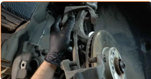
**16** Rengør bremseskivebefæstigelsen. Brug en stålbørste. Brug WD-40 spray.
