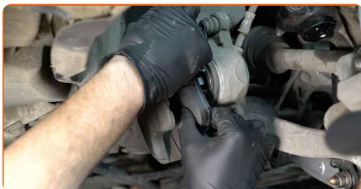
**28** Monter bremsekaliberen og sæt den fast. Brug en topnøgle N°13. Brug en momentnøgle. Stram den til 30 Nm moment.
