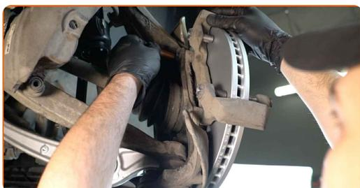
**24** Stram bremsekaliberens beslag. Brug en topnøgle №21. Brug en momentnøgle. Stram den til 196 Nm moment.
