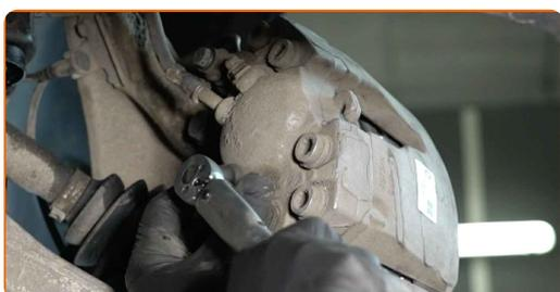
**29** Monter bremsekaliberens holdefjeder.
