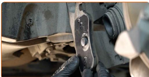
**13** Rengør bremsekaliberens befæstigelse. Brug en stålbørste. Brug WD-40 spray.
