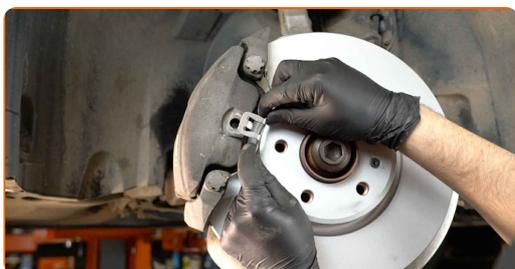
**30** Behandle overfladen hvor bremsekiven har kontaktflade til hjulnavet. Brug kobberfedt.
