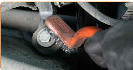
**7** Løsne befæstigelsen der forbinder krængningsstabilisatoren med bæreamen. Brug en topnøgle №16. Brug en skraldenøgle.
