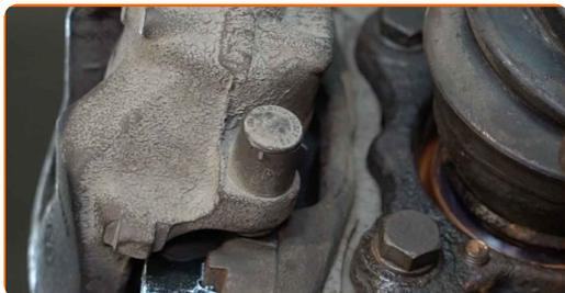
**30** Monter bremsekaliberens holdefjeder. Brug et koben.
