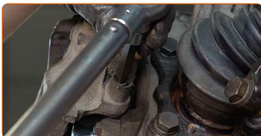
**29** Monter støvhætter på bremsekaliberens styretapper.
