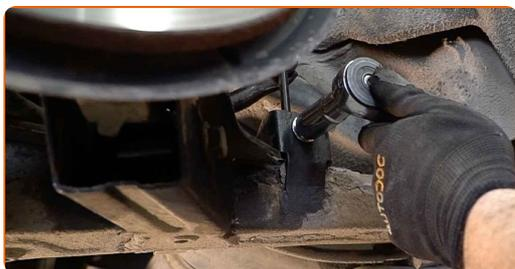
**79** Rens hjulets montagesæde. Brug en stålbørste. Behandl kontaktfladen. Brug kobberfedt.
