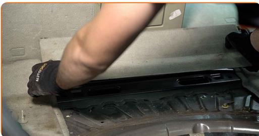
**9** Fjern klipsene til bagagerummets side foring. Brug et panelclip værktøj.
