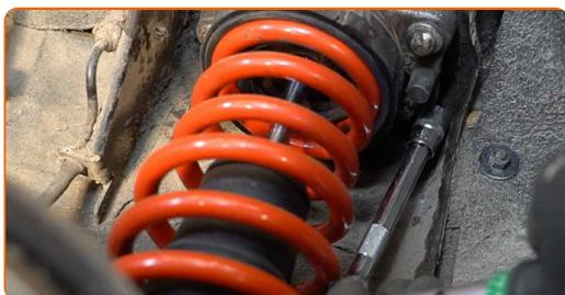
**78** Stram befæstigelsen der forbinder krængningsstabilisatoren med bæreamen. Brug en kombinøgle № 18. Brug en topnøgle №18. Brug en momentnøgle. Stram den til 55 Nm moment.
