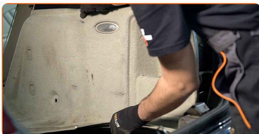
**17** Fjern sikkerhedsselens beklædningsdæksel. Brug en topnøgle N°10. Brug en skraldenøgle.
