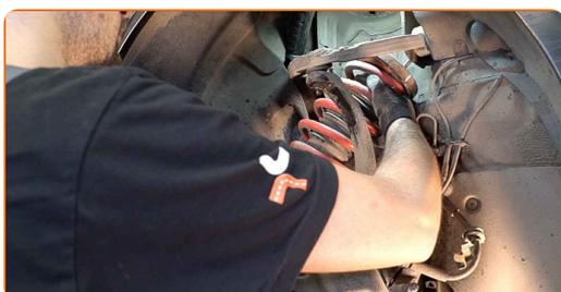
**20** Støt armen. Brug en hydraulisk løfteenhed.
