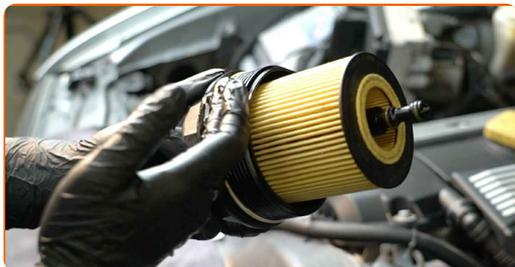
22 Monter et nyt oliefilterhus og stram det. Brug en topnøgle N°36. Brug en momentnøgle. Stram den til 25 Nm moment.
