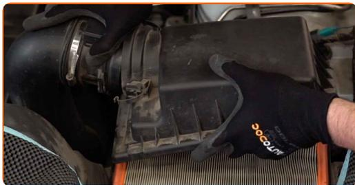
**6** Fjern filterelementet fra filterhuset.
