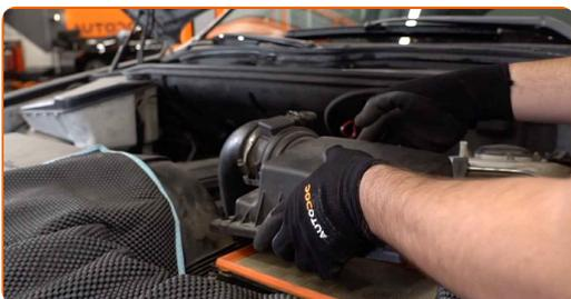
**5** Afbryd luftindsugningsrør fra luftfilterhuset.
