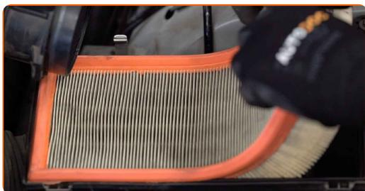
**7** Før rengøring af luftfilterdæksel og hus, dæk luftkanal delene, luftstrømsfølere (hvis tilgængelig), gasspjæld med en ren klud.
