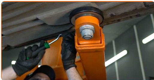
**8** Fjern undervognspanelet.
