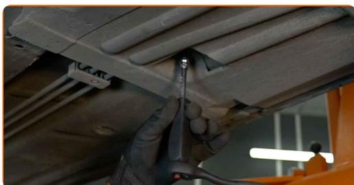
**7** Fjern clipsene fra undervognspanelet. Brug et panelclip værktøj.
