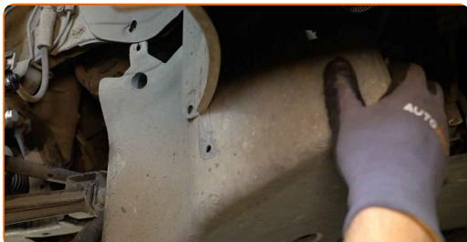
**6** Træk poly V-rem remstrammeren til side. Brug en kombinøgle № 19.
