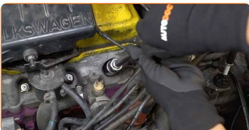
**9** Skru nye tændrør i og stram dem. Brug tændrørsnøgle #21. Brug en momentnøgle. Stram den til 25 Nm moment.
