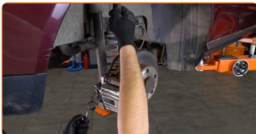
**Udskiftning: bremsekaliber – AUDI A3 Hatchback (8P1). Råd fra AUTODOC eksperter:**
