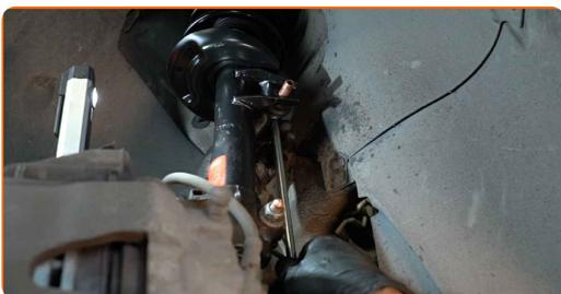
**12** Spænd stabiliseringsstiverens fastgørelse til. Brug en kombinøgle N° 18. Brug en topnøgle N°18. Brug en skraldenøgle.
