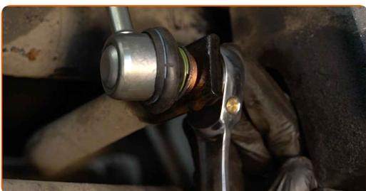
**13** Spænd befæstigelsen til der forbinder forbindelsesstangen med fjederbenet. Brug en topnøgle N°18. Brug en momentnøgle. Stram den til 65 Nm moment.
