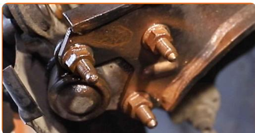
**41** Behandle overfladen hvor bremseskiven har kontaktflade til hjulnavet. Brug keramisk fedt.
