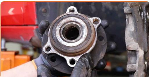
**27** Rengør navlejts monteringsæde. Brug en stålbørste. Brug WD-40 spray.
