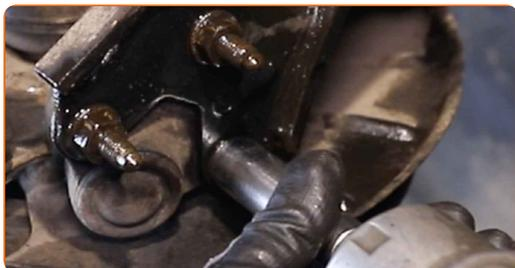
**15** Rengør bremseskive befæstigelse. Brug en stålbørste. Brug WD-40 spray.
