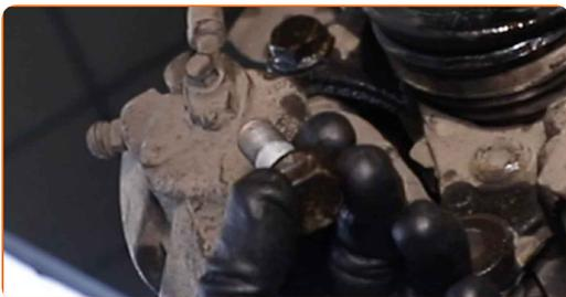
**12** Fjern bremsekaliberen sammen med bremseåget.
