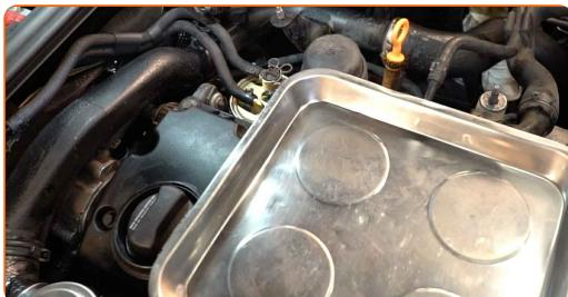
8 Skru filterhusets dæksel af sammen med det gamle oliefilter element. Brug 76-14F spændenøgle. Brug en skraldenøgle.
