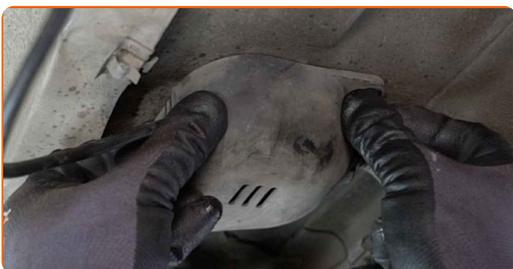
**16** Forbind ledningen til oxygen sensoren.
