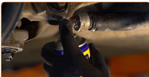
7 Skru befæstgelsen af, der forbinder sportstangen med krængningsstabilisatoren. Brug en kombinøgle № 16. Brug en topnøgle №16. Brug en skraldenøgle.
