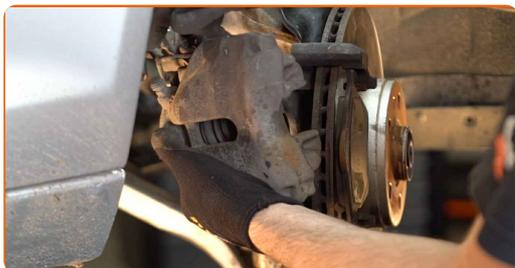
Udskiftning: bremseklodser – AUDI A6 Avant (4F5, C6). AUTODOC eksperter anbefaler:
