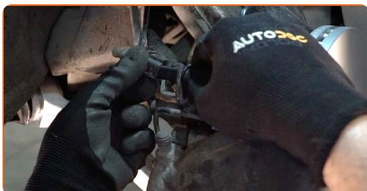
**22** Monter bremsekaliberens holdefjeder. Brug et koben.
