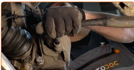
**11** Løsgør bremsekaliber låsefjeder. Brug et koben.
