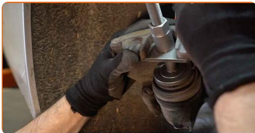
**17** Behandel bremseklodserne på kontakfladerne hvor de kommer i kontakt med bremsekaliber åget. Brug anti-hvin smøremiddel.
