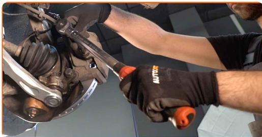
**20** Monter støvhætter på bremsekaliberens styretapper.
