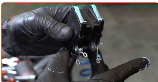
Udskiftning: bremseklodser – AUDI A6 C4 Avant (4A5). Råd fra AUTODOC eksperter:
