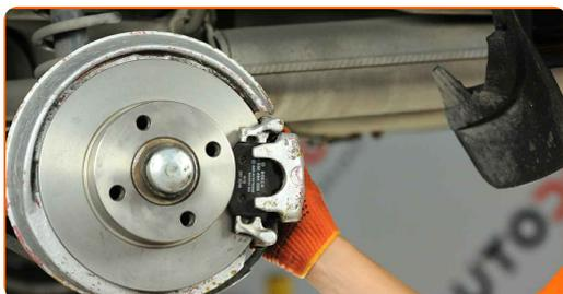
**17.2** Brug en kombinøgle № 15. Brug en kombinøgle № 13. Brug en momentnøgle. Stram den til 35 Nm moment.
