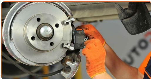
Udskiftning: bremseklodser – AUDI A6 C4 Avant (4A5). AUTODOC eksperter anbefaler:
