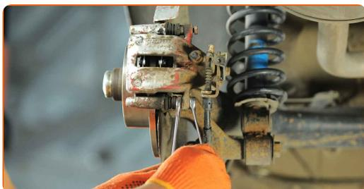
**18** Behandle overfladen hvor bremsekiven har kontaktflade til hjulnavet. Brug varmebestandig keramisk fedt.
