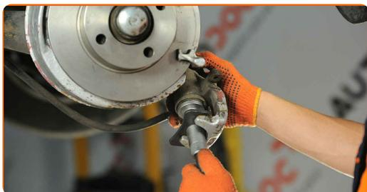
**17.1** Monter bremsekaliberen og sæt den fast.
