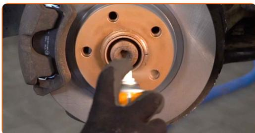
**31** Rengør bremseskivens overflade. Brug bremsrens.
