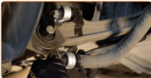
**12** Støt armen. Brug en hydraulisk løfteenhed.
