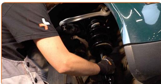
**47** Skru tårnlejet af stiverens beslag. Brug en topnøgle N°15. Brug en skraldenøgle. Spænd den ikke til.
