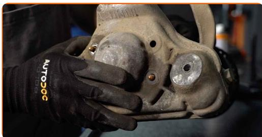
**45** Stram den øvre møtrik på støddæmperens topbeslag. Brug en topnøgle N°13. Brug en momentnøgle. Stram den til 22 Nm moment.
