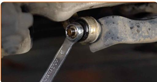
**18** Løsne befæstigelsen der forbinder krængningsstabilisatoren med bæreamen. Brug en kombinøgle N° 16 (2 dele).
