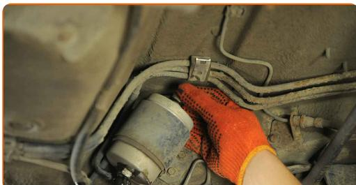
**7** Rengør brændstoffilter beslaget. Brug en stålbørste. Brug WD-40 spray.
