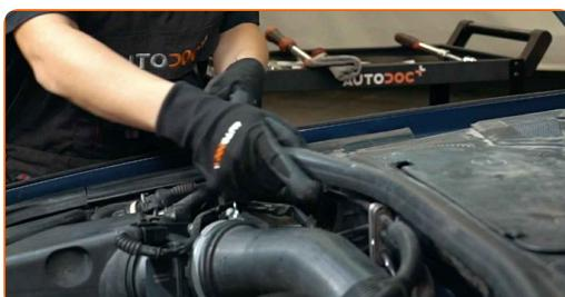
**4** Skru befæstigelserne af på torpedopladen. Brug Torx T20. Brug en skruetrækker med lige kærv.
