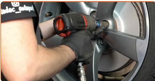
**46** Sænk bilen og stram hjulboltene på kryds med. Brug hjul slagnøgle #17. Brug en momentnøgle. Stram den til 120 Nm moment.
