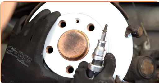
**18** Stram bremseskivens skruer. Brug Torx T30. Brug en momentnøgle. Stram den til 4 Nm moment.
