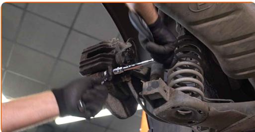
**11** Fjern bremsekaliberen.
