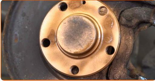
**16** Fjern anti-korrosions fedt fra den nye bremseskive. Brug bremsrens.
