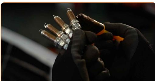
**12** Installer det nye tændrør i monteringsfordybningen. Brug tændrørsnøgle #16.
